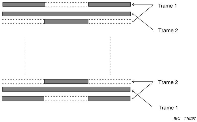
Figure 29 – Mire utilisée pour contrôler l'entrelacement
