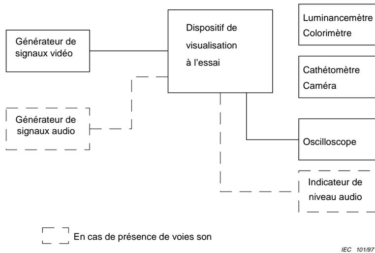
Figure 15 – Synoptique de principe du montage de mesure
