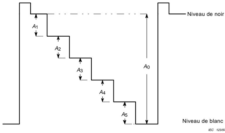
Figure 36 – Mesure des non-linéarités de l'amplitude
