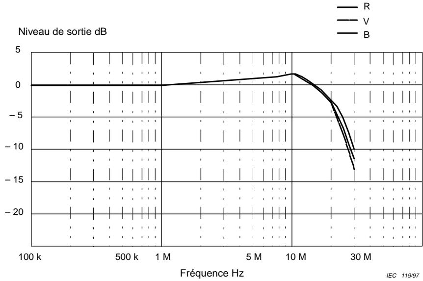
Figure 32 – Exemple de caractéristiques amplitude-fréquence
