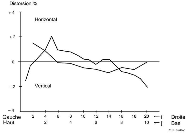
Figure 17 – Exemple de non-linéarité géométrique
