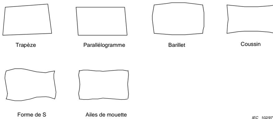
Figure 16 – Exemples de distorsions du contour
