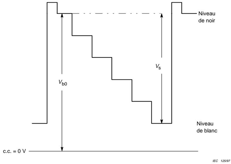
Figure 38 – Mesure de la stabilité du niveau de noir
