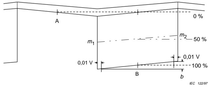
Figure 35 – Réponse en signal carré à la fréquence de trame
