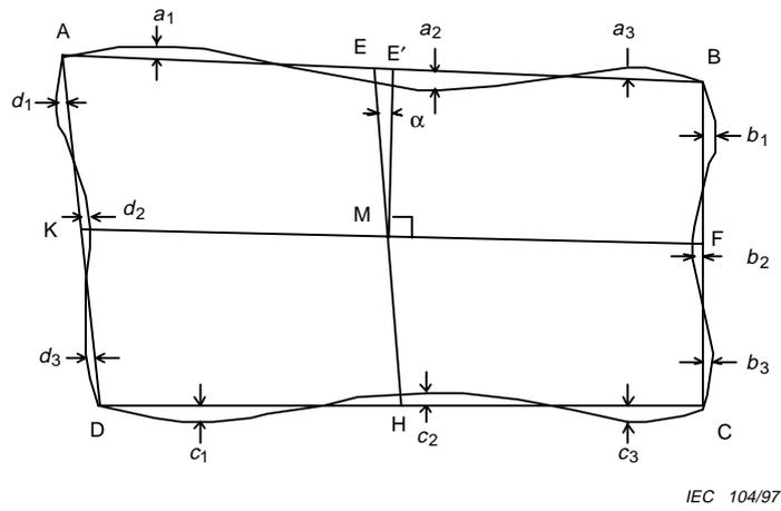
Figure 18a – Points de mesure des valeurs de distorsion du contour
