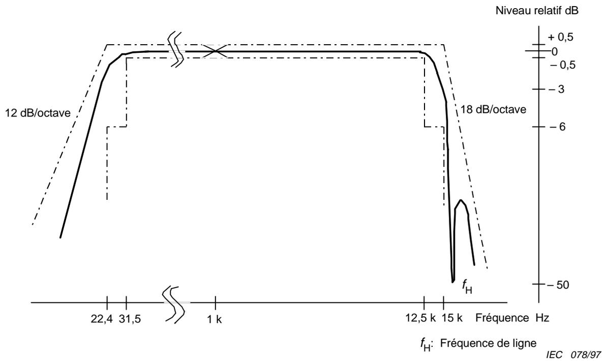
Figure 2 – Filtre passe-bande 22,4 Hz à 15 kHz
