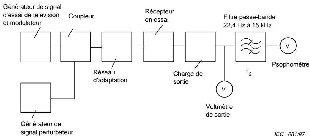
Figure 5 – Mesure du rapport signal RF utile à perturbateur
