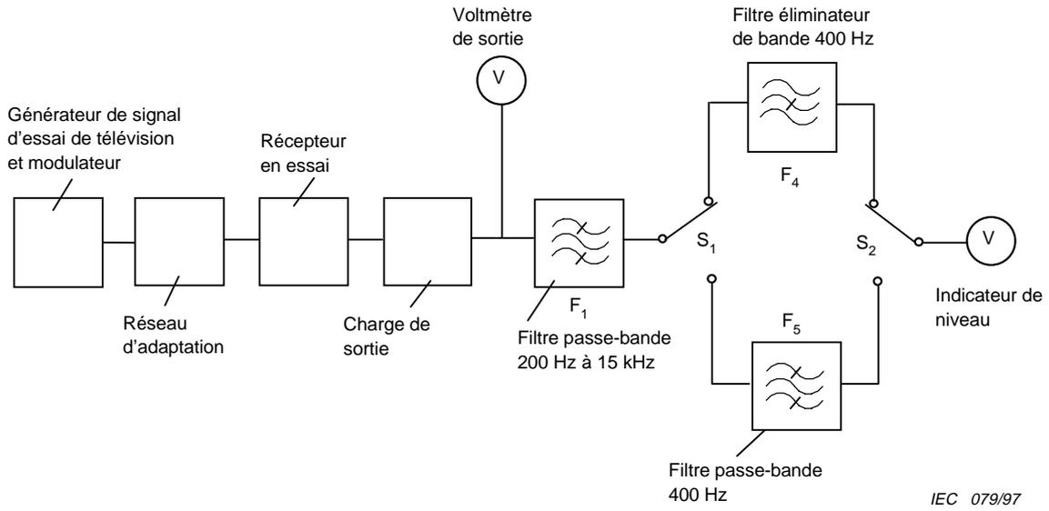
Figure 3 – Mesure du rapport de suppression de la modulation d'amplitude
