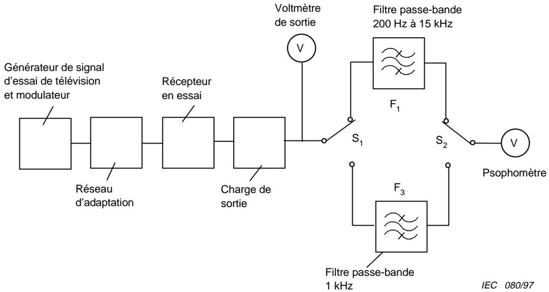
Figure 4 – Mesure du rapport signal à bruit
