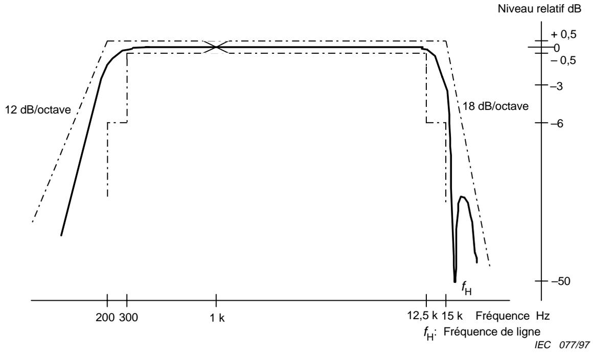
Figure 1 – Filtre passe-bande 200 Hz à 15 kHz
