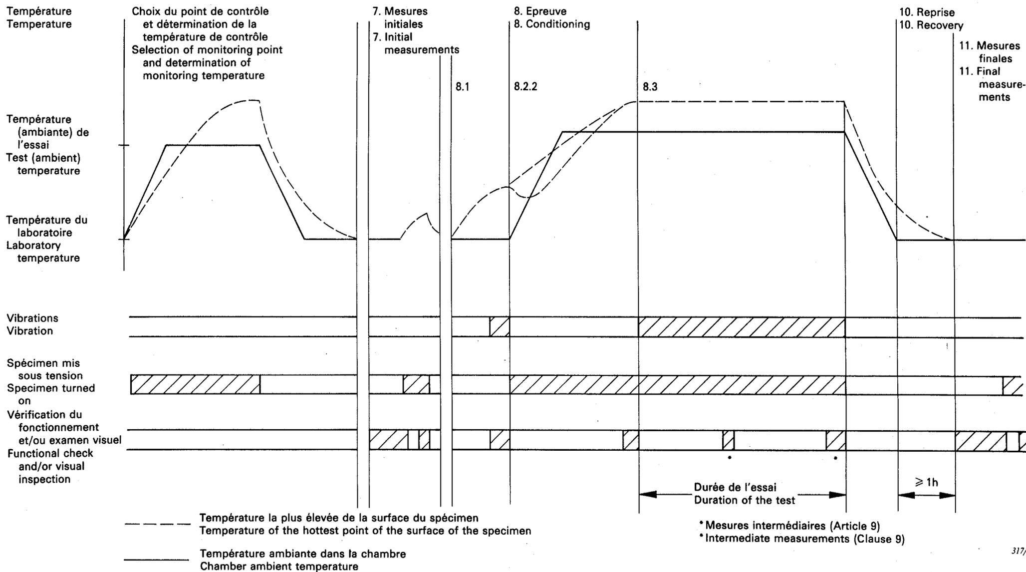
FIG. 2. — Diagramme de l'essai par spécimens dissipant d'énergie.
