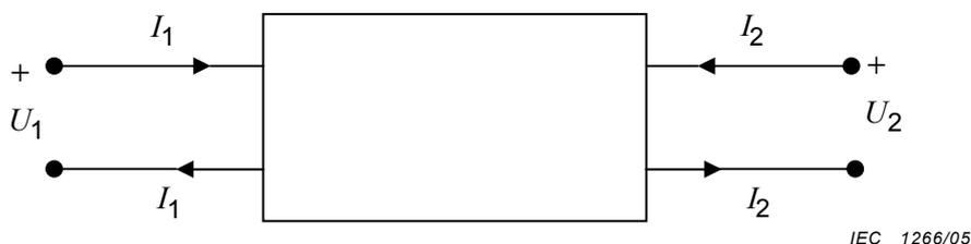
**Figure 1 – Conventions concernant les signes dans les circuits électriques**
