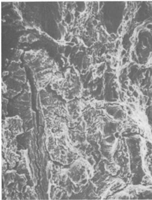
(c) \Delta K = 39.2 \text{ ksi}\sqrt{\text{in.}} (43.4 MPa \sqrt{\text{m}} ) |20 \mu\text{m} | (d) \Delta K = 55.5 \text{ ksi}\sqrt{\text{in.}} (61.5 MPa \sqrt{\text{m}} )
