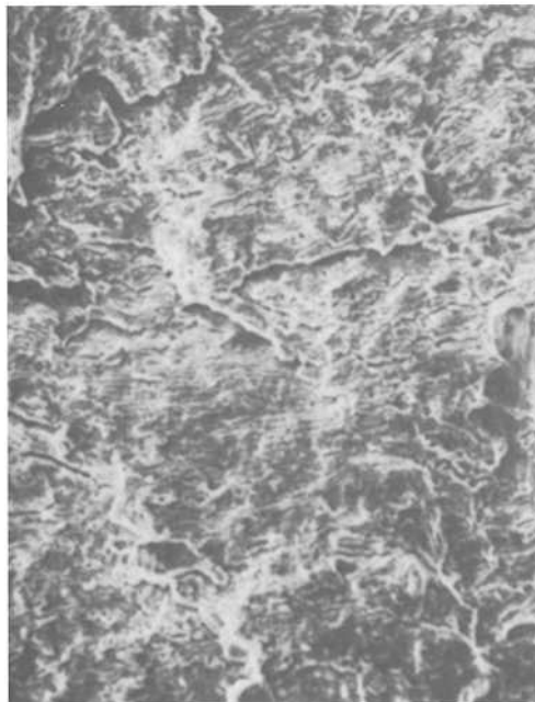
(d) \Delta K = 83.4 \text{ ksi}\sqrt{\text{in.}} ( 92.4 \text{ MPa}\sqrt{\text{m}} ) |20 \mu\text{m}|
