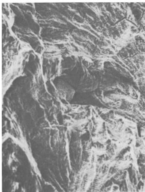
(c) \Delta K = 32.7 \text{ ksi}\sqrt{\text{in.}} (36.1 MPa \sqrt{\text{m}} ) \left[20\mu\text{m}\right] (d) \Delta K = 39.4 \text{ ksi}\sqrt{\text{in.}} (43.6 MPa \sqrt{\text{m}} ) \left[20\mu\text{m}\right]
