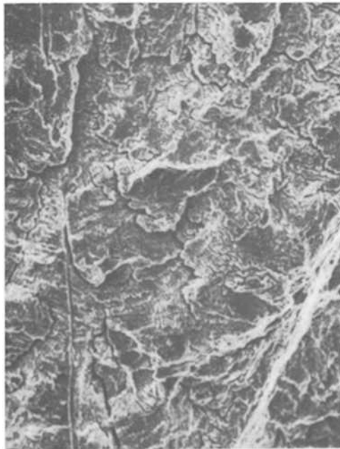
(c) \Delta K = 39.2 \text{ ksi}\sqrt{\text{in.}} (43.4 MPa \sqrt{\text{m}} ) |20 \mu\text{m} | (d) \Delta K = 55.5 \text{ ksi}\sqrt{\text{in.}} (61.5 MPa \sqrt{\text{m}} )
