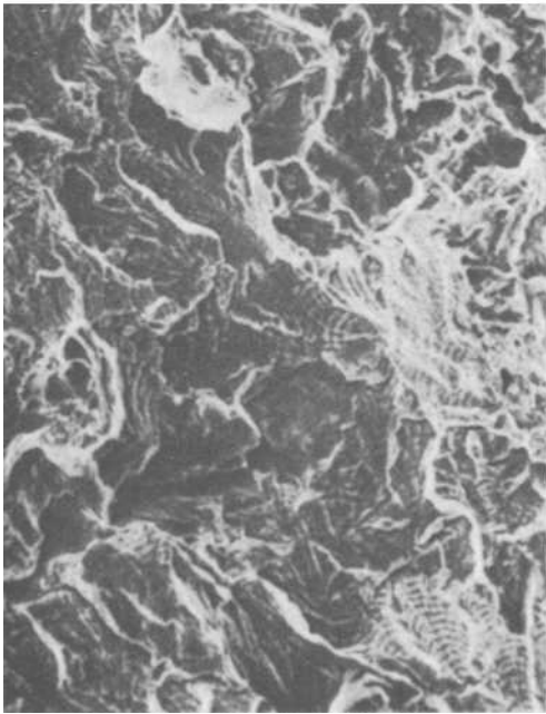
(d) \Delta K = 54.3 \text{ ksi}\sqrt{\text{in.}} (60.1 MPa \sqrt{\text{m}} )
