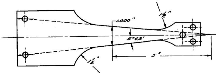
(d) Plate Fatigue Specimen (Krouse Type).
