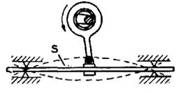
(d) Simple Beam Actuated by Crank or Cam.
