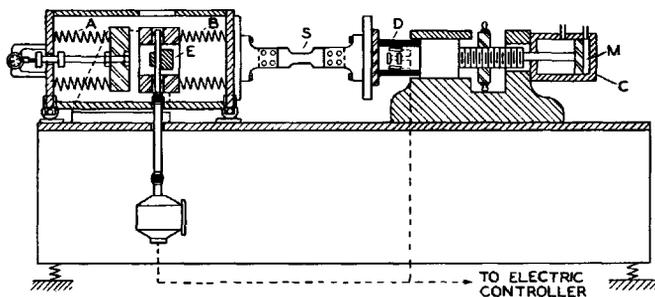
(d) Single-Weight Mechanical Oscillator Type Machine—Sonntag.
