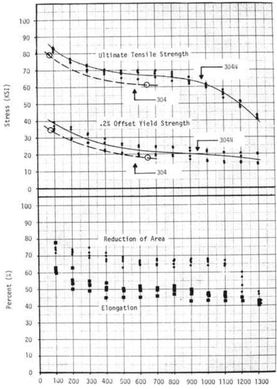
FIG. 4—Type 304N stainless steel hot tensile data.
