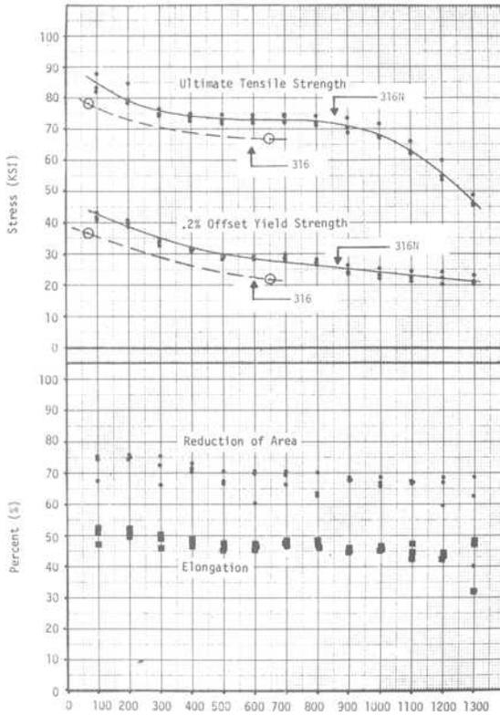
FIG. 5—Type 316N stainless steel hot tensile data.
