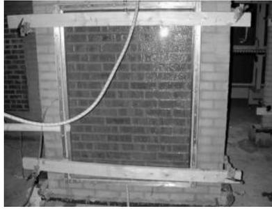
FIG. 1—*E 514-04 test chamber.*
