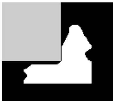
FIG. A1.3 Acceptable Electrode Edge Radius
