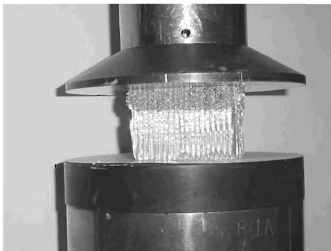
Рисунок 2 — Сведение нагрузочных плит вокруг сжимаемого образца
