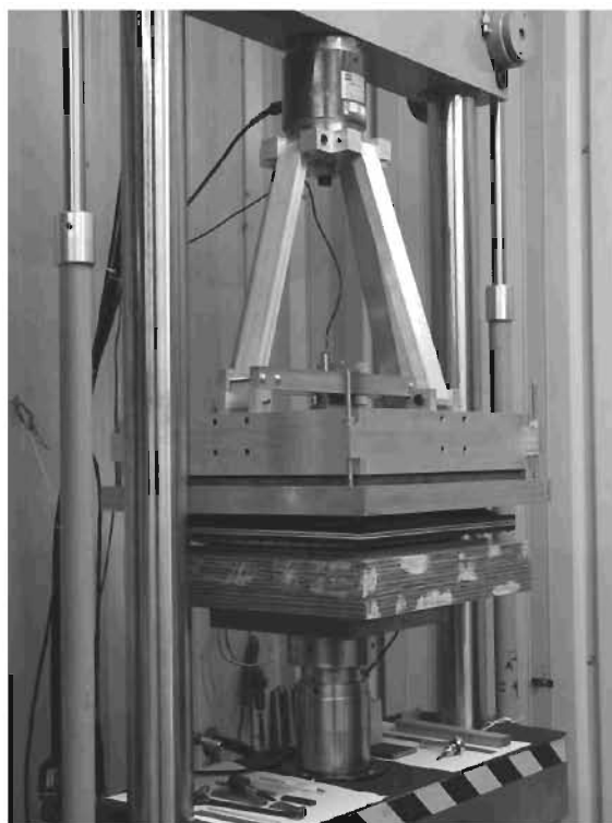
Рисунок 3 — Аппарат для проведения испытания на изгиб пластины в плоскости
