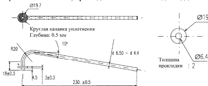
Рисунок 11 - Экстракционная трубка (нержавеющая сталь) с прокладкой (Детали 3 и 4 Рисунка 7)
