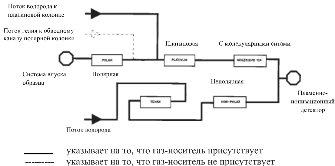
Рисунок 12 – Конечное элюирование неполярной колонки
