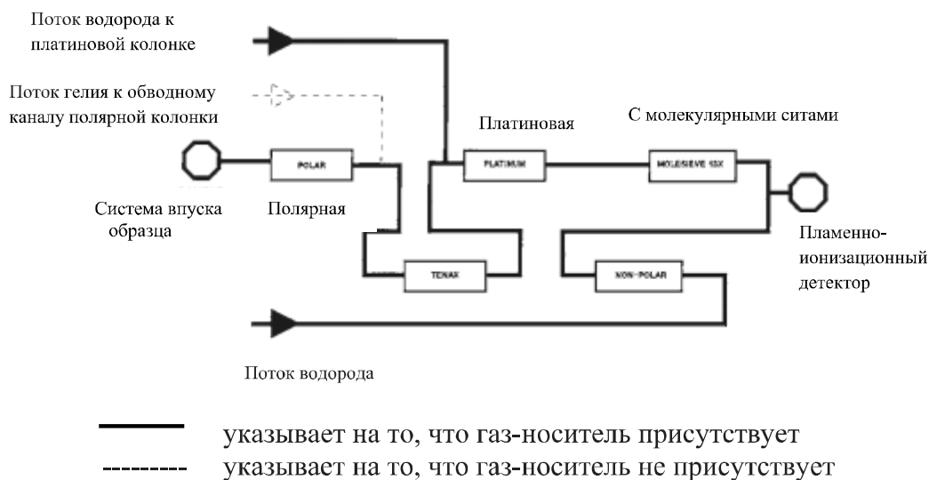
Рисунок 13 – Обратная циркуляция неполярной колонки к детектору
