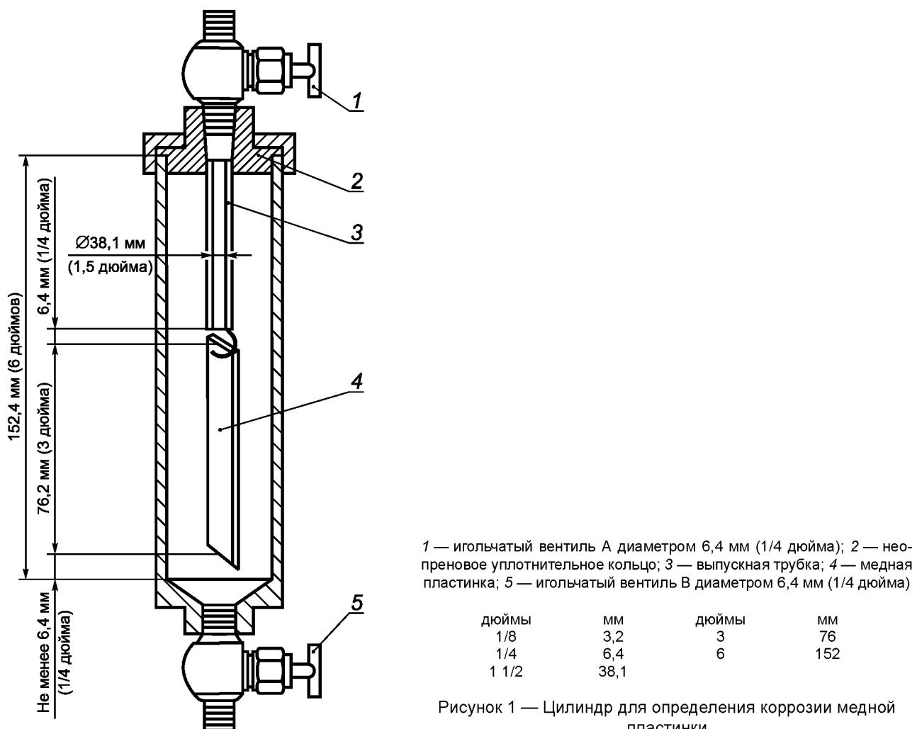
6.1.1 Для присоединения трубы диаметром 6,4 мм (1/4 дюйма) используют поворотные соединения с адаптером.
