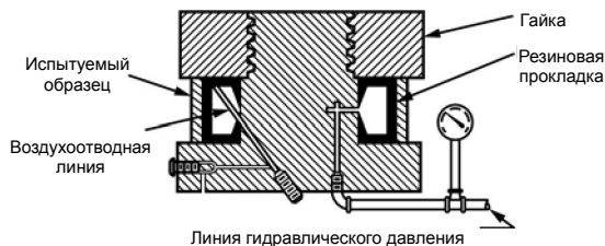
РИС. А2.6 Устройство для испытания по определению поперечного предела текучести кольцевых образцов
