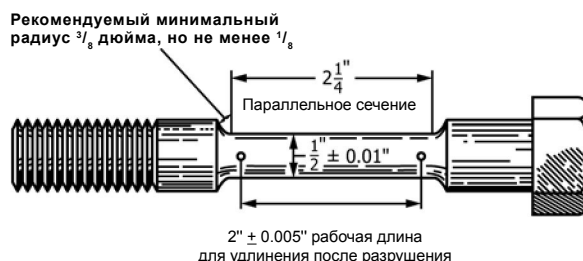
РИС. А3.3 Образец болта со скошенным стержнем для испытания на растяжение
