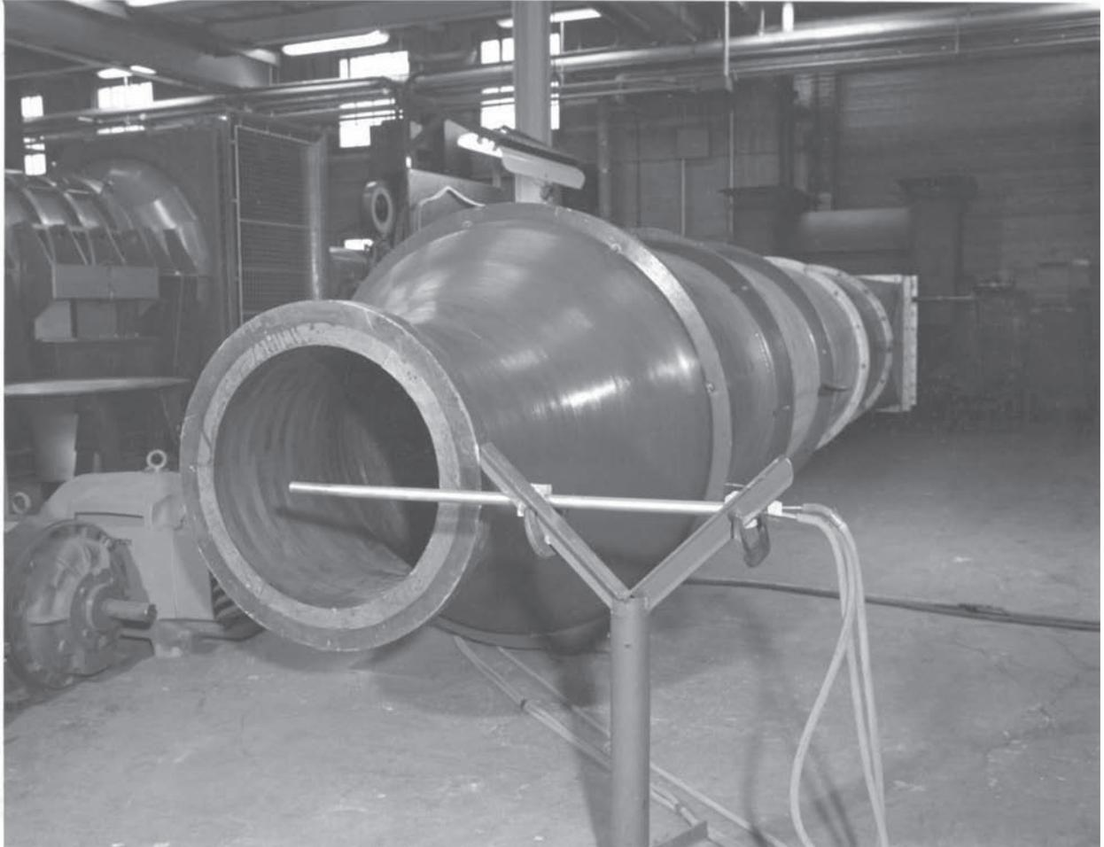
Fig. 4-6.4-2 ASME Flow Chamber
