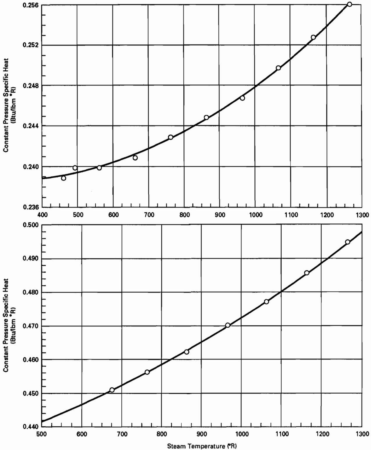
**FIG. C.1(b) IDEAL GAS SPECIFIC HEAT FOR STEAM**
