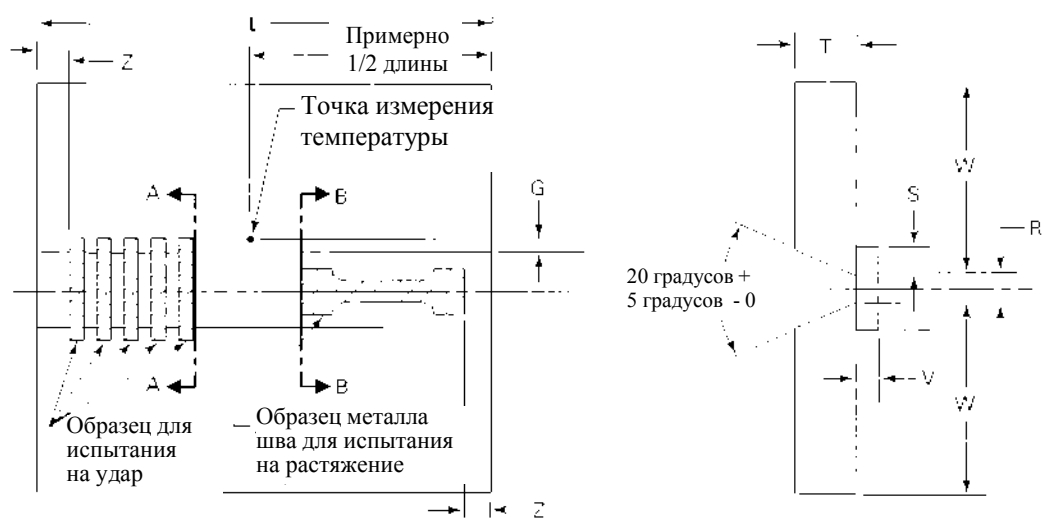
(А) Расположение испытательных образцов на испытательной пластине
