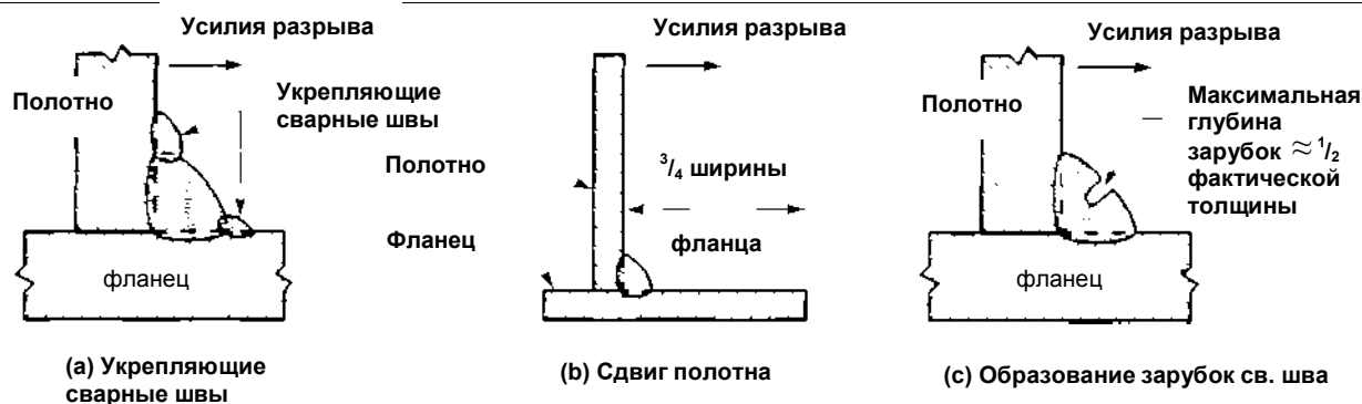
РИС. 9 ВОЗМОЖНЫЕ ВАРИАНТЫ РАЗРУШЕНИЯ УГЛОВОГО СВАРНОГО ШВА
