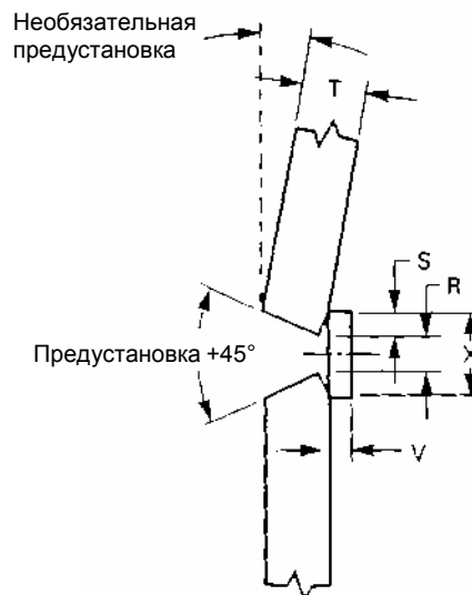
(В) Подготовка канавок на испытательной пластине
