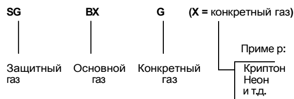
РИС. 4 СИСТЕМА КЛАССИФИКАЦИИ ДЛЯ ЗАЩИТНЫХ ГАЗОВ, ИМЕЮЩИХ В ОБОЗНАЧЕНИИ ЭЛЕМЕНТ «X»
