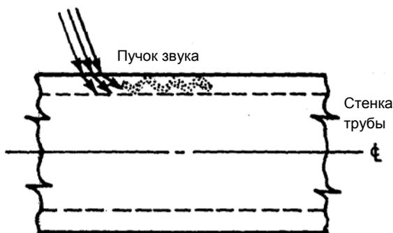
в стенке трубы должно происходить в осевом направлении, а не кольцевом, и в соответствии с требованиями КЕ-241(а). Рис. КЕ-242.1 иллюстрирует типичное вхождение звука в стену трубы под углом в осевом направлении распространения ультразвуковой энергии для обнаружения поперечных засечек.
