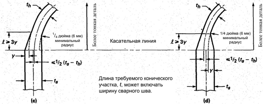
Соединения между сформованными днищами и корпусами
