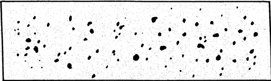
СКРУГЛЕННЫЕ ИНДИКАТОРНЫЕ СЛЕДЫ, РАСПОЛОЖЕННЫЕ СЛУЧАЙНЫМ ОБРАЗОМ
