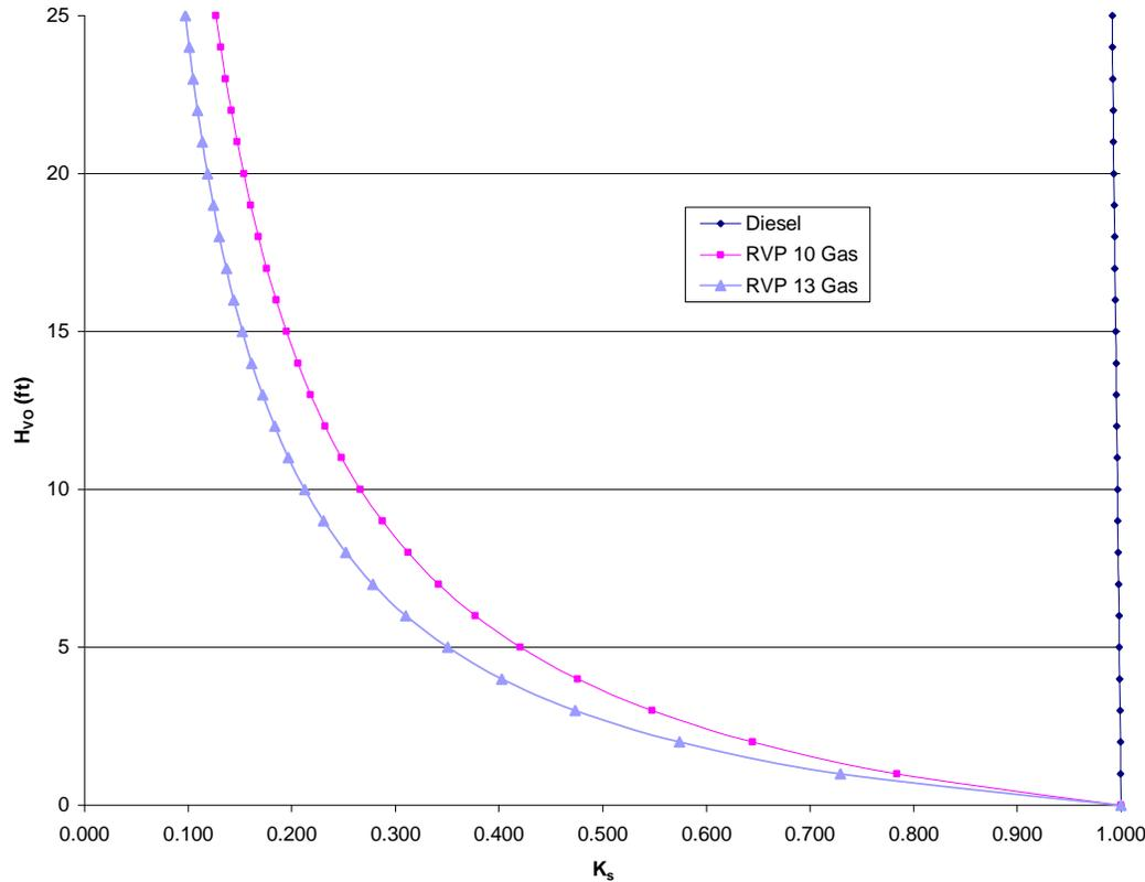
Figure 1— $K_s$  Saturation Factor
