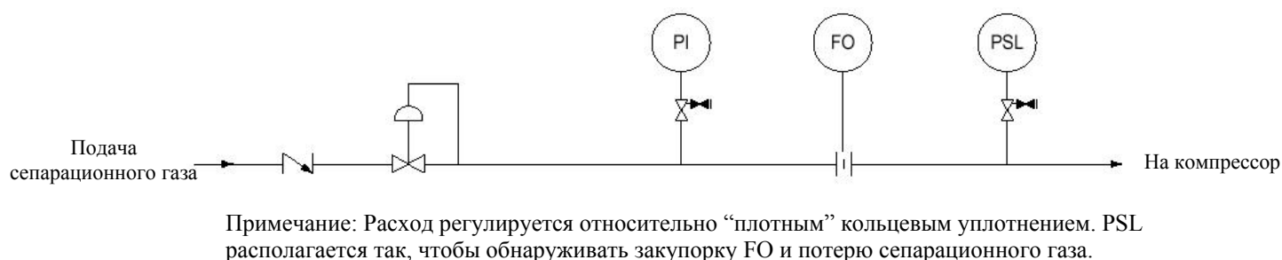
Рисунок 4А-9б—Модули Сепарационного Газа (Вариант 2) (Буферизованное кольцевое уплотнение с дистанционным отводом)
