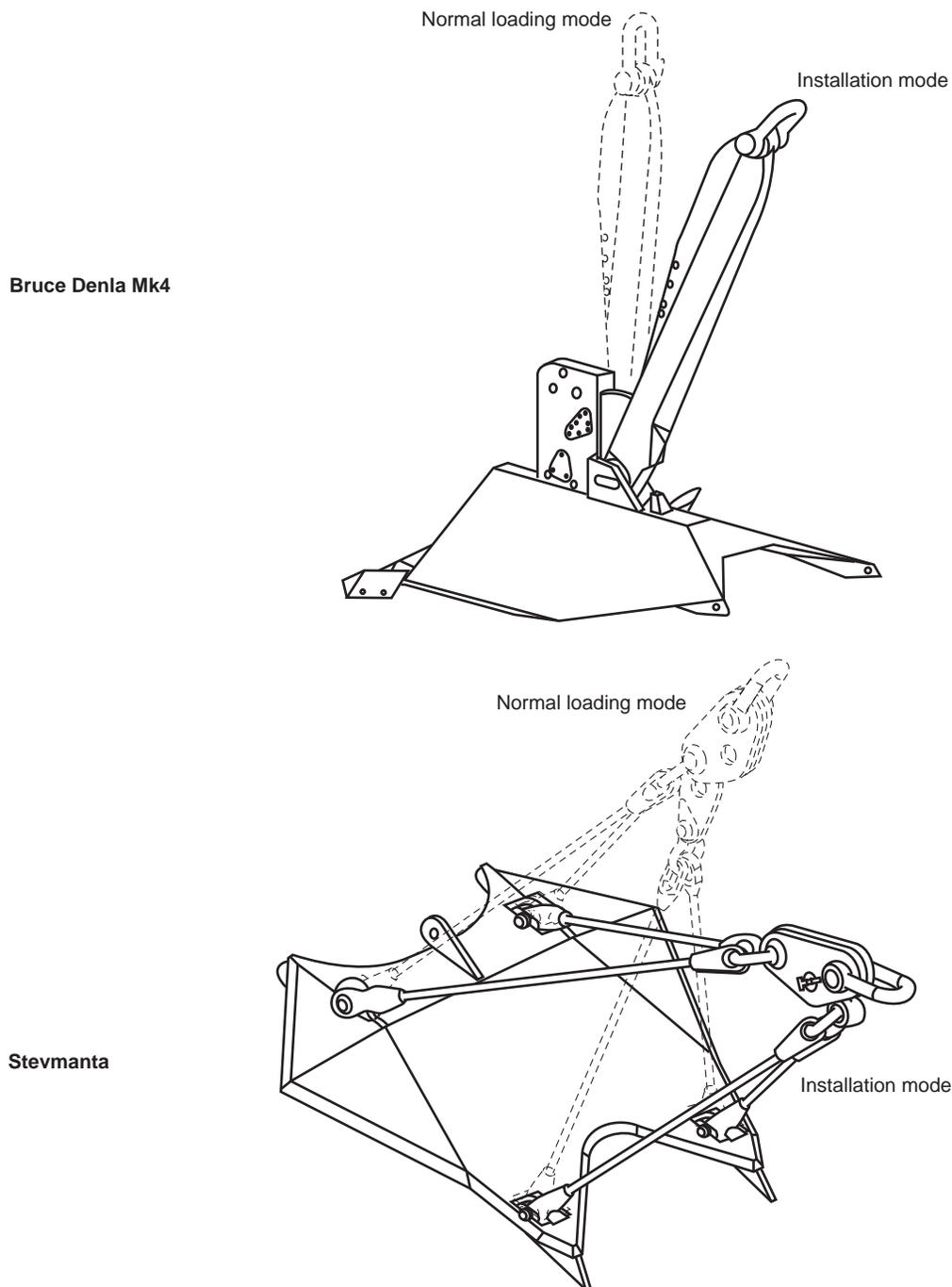
Figure A.15—Drag Embedded Plate Anchor (VLA)
