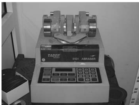
7.1 Taber test apparatus.
