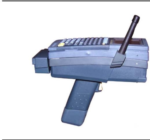
**Figure C-11. Hand Held RFID Interrogator**
