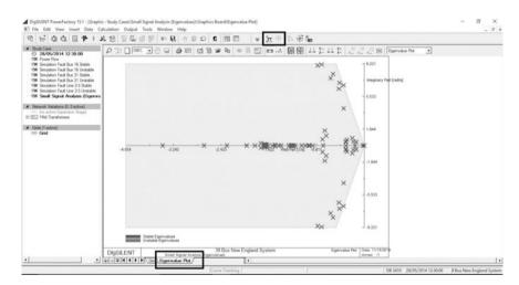
Fig. 11.41 DIgSILENT PowerFactory—Eigenvalue Plot
