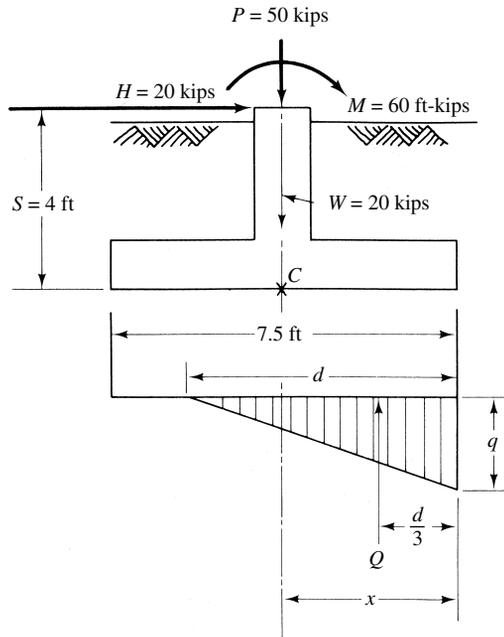
$$60 \text{ ft-kips} + 80 \text{ ft-kips} - 262.5 \text{ ft-kips} + \frac{70 \text{ kips}}{3}d = 0$$
