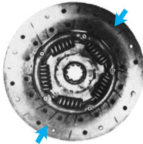
(d) Wear Pattern from Warped Pressure Plate
