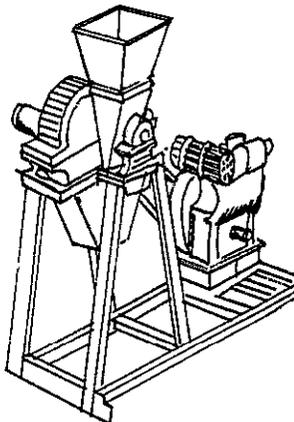
**BOTTOM DISCHARGE HAMMER MILL**
