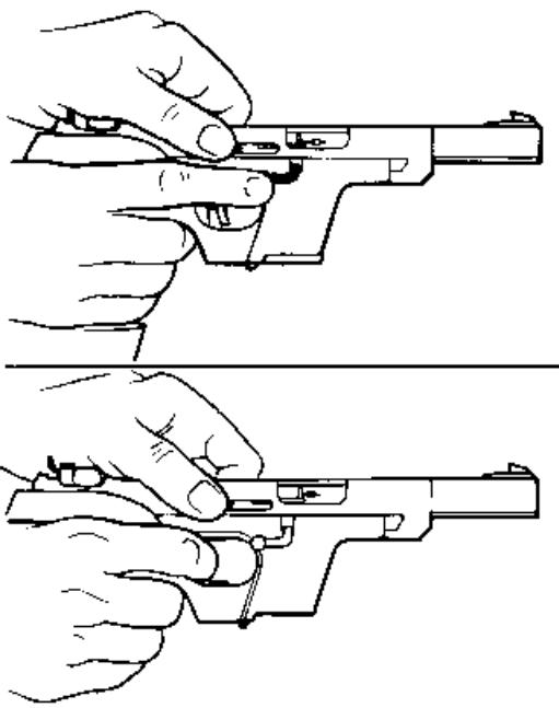
Nach dem letzten Schuß Verschluß zurückziehen und dabei Verschlußfanghebel mit dem Zeigefinger nach oben drücken. Der Verschluß bleibt geöffnet stehen. Prüfen ob keine Patrone mehr im Lauf ist. Wird weitergeschossen, Magazin auswechseln, dann Verschlußfanghebel nach unten drücken. Der Verschluß geht nach vorn, die erste Patrone wird in den Lauf eingeführt.
