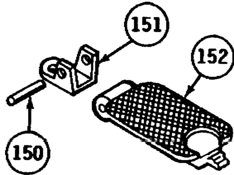
c. Straight pin (150), hinge (151), and door assembly (152)
