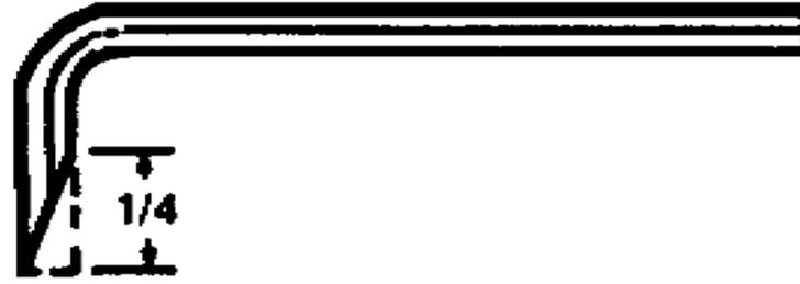
**FABRICATE FROM 1/16 IN. SOCKET HEAD SCREW KEY
