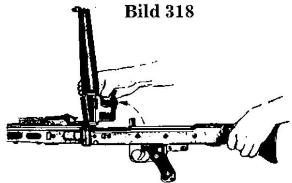
4. bei senkrecht zur Rohrachse hochgestelltem Deckel und Zuführerunterteil Deckelbolzen nach links herausziehen. Deckel und Zuführerunterteil abnehmen.
