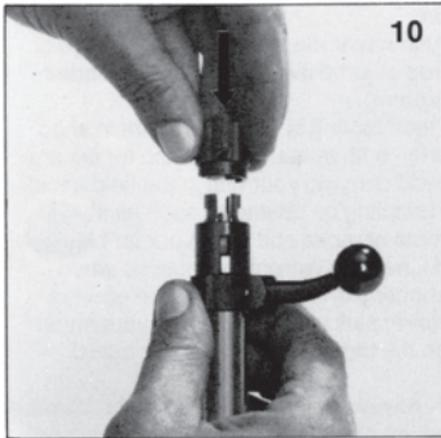
**10.** Sicherung komplett in Pfeilrichtung aufstecken. Dabei beachten, daß Sicherungsflügel in Flucht zum langen Kammer Schlitz steht und daß der Signalstift zentrisch einrastet (Abb. 10).
