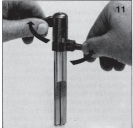
**11.** Kammergriff und Sicherung in Pfeilrichtung drehen, dabei Sicherung in Anlage drücken (Abb. 11). Das Schloß ist nun komplett montiert und gespannt.
