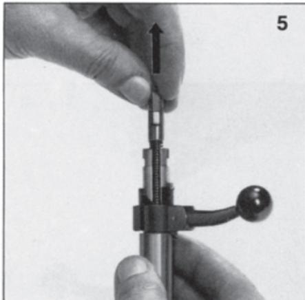
**5.** Den kompletten Schlagbolzen in Pfeilrichtung herausnehmen (Abb. 5).
