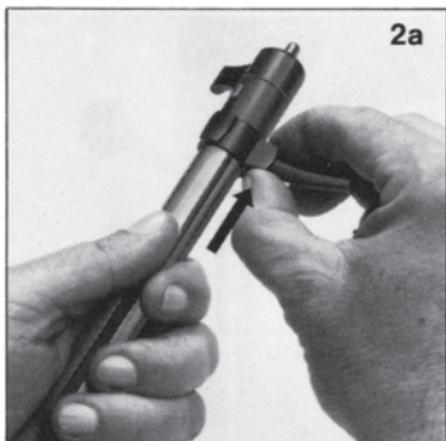
**2a. Achtung:** Bei Gewehren der Modellgruppe 1742 ist vorher der Rastbolzen an der Unterseite des Kammergriffes in Pfeilrichtung zu drücken (Abb. 2a).
