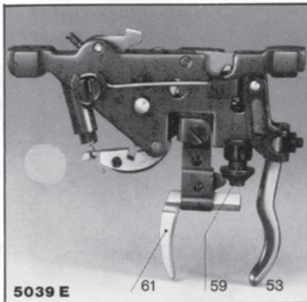
Steckerabzug 53 rastet beim Vordrücken nicht mehr ein. Jetzt dreht man die Schraube wieder ca. 1/8 Umdrehung nach rechts. Übertriebene Feineinstellung ist nicht zu empfehlen, da sie zur Selbstauslösung führen kann.
