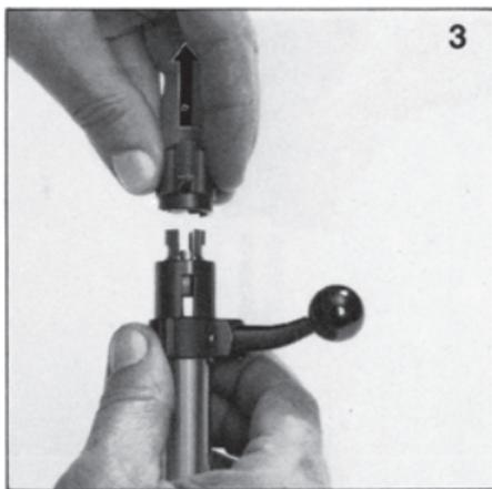
**3.** Kammer senkrecht halten und Sicherung nebst Signalstift und Feder in Pfeilrichtung nach oben abheben (Abb. 3).
