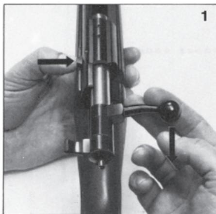
1. Schloßhalter links an der Hülse drücken und Schloß in Pfeilrichtung nach hinten herausziehen (Abb. 1). So entfernen Sie das Schloß aus der Hülse.
