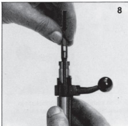
**8.** Kompletten Schlagbolzen in Pfeilrichtung lagerichtig bis zum Nutgrund am Kammergriff einstecken (Abb. 8).
