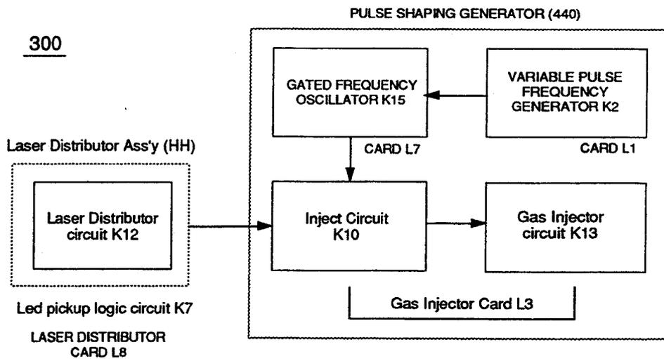
FIGURE 3-4: INJECTOR CONTROL CIRCUIT
