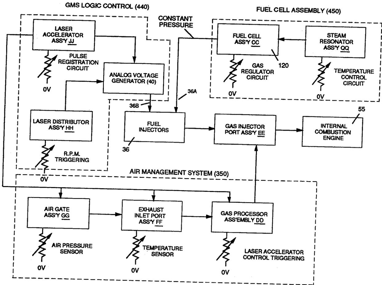
FIGURE 3-1: HYDROGEN GAS MANAGEMENT SYSTEM
