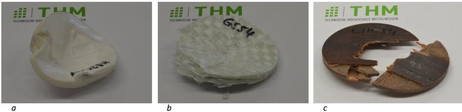
**Abbildung 4.1** Sondervarianten: PE-Gewebe Dyneema HB26 (a), Glasfasern DuroProtect 1000 (b), Rotbuchenfurnier LignoProtect (c). Der Probendurchmesser beträgt initial 60 mm.
