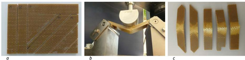
**Abbildung 8.2** DuroProtect 5000 - Biegeversuche: Entnahme der Biegeproben aus der Musterplatte in unterschiedlicher Orientierung (a), Durchführung der Drei-Punkt-Biegeversuche mit deformierter Biegeprobe (b), deformierte Biegeproben mit Versagen nach der Versuchsdurchführung im Vergleich (c). Die ursprünglichen Plattenabmessungen entsprechen einem DIN A4 Format mit einer Dicke von 10 mm.
