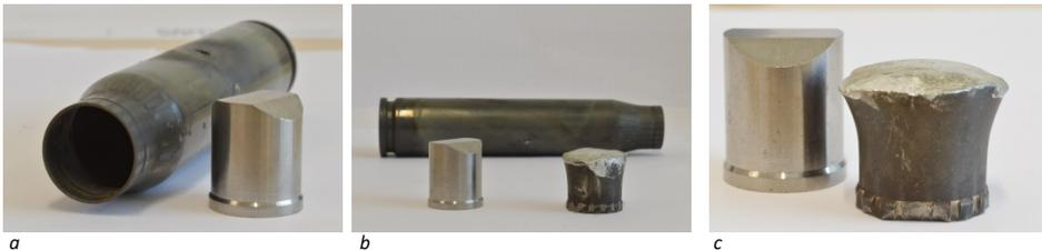
**Abbildung 4.2** Splitterdarstellungsgeschoss (FSP): FSP mit einem Durchmesser von 20 mm vor dem Laden mit einer Hülse der Gesamtlänge 139 mm (a); FSP vor und nach dem Durchschuss vor einer Hülse (b); FSP vor und nach dem Durchschuss im Detail (c).
