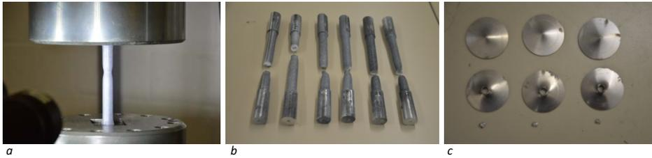
**Abbildung 6.4** Aluminium AA7020-T651 - deformierte Zugproben: Probe in der Einspannung (a), Proben nach dem Bruch (b), deformierte Durchstoßproben: Proben mit ausgestanztem Material (c).
