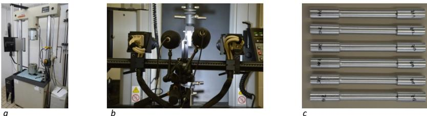
**Abbildung 6.2** Aluminium AA7020-T651 - Zugversuche, Versuchskonfiguration: Servohydraulische Zugmaschine Schenck PSB (a), Optisches Messsystem GOM Aramis 12M (b), Rund-Zugproben (c).
