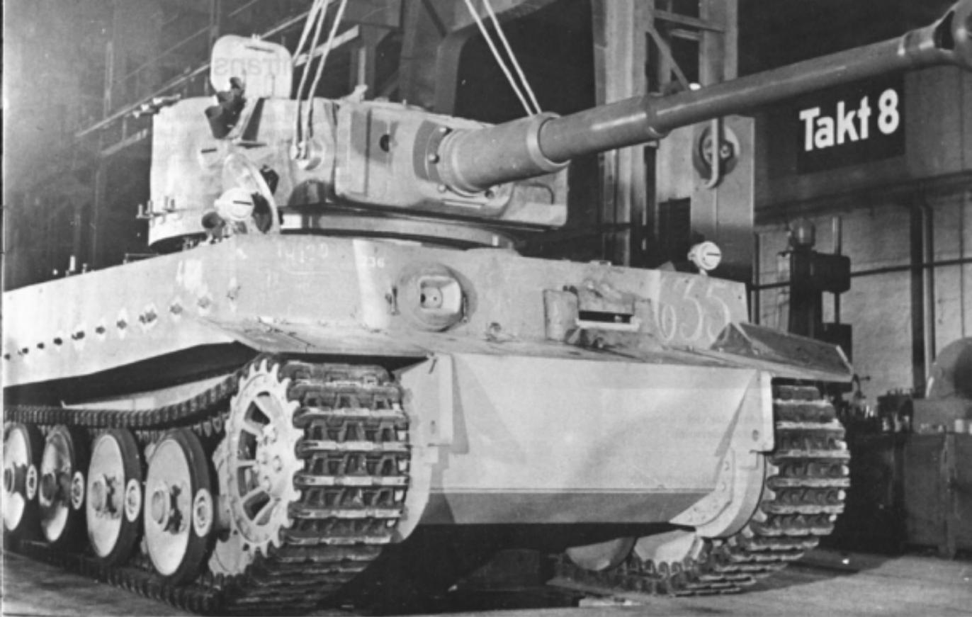
Auf diesem Foto ist der "Takt 8" abgebildet. Er hat die Montage des Turmes in die fast fertige Wanne zum Inhalt. Am Laufwerk fehlen noch die äußeren Laufrollen. Diese werden erst mit der Gefechtskette aufgesetzt.
