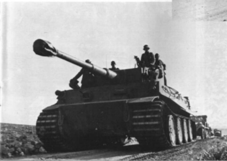
Beide Fotos stammen vom Einsatz der schweren Panzerabteilung 501 in Tunis 1943. Auf dem obigen Bild ist neben dem Tiger ein Horch-Kübel (Kompaniechefwagen) erkennbar. Nach seinem taktischen Zeichen am vorderen Kotflügel gehört er zu einer Panzergrenadiereinheit. Die 8,8 cm-Kanone des Tiger trägt gegen den Staub einen Mündungsschoner über der Mündungsbremse.
