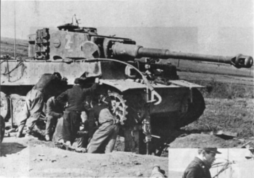
Links und unten ist derselbe Panzer zu sehen. Über einer provisorischen Grube ist der Tiger aufgebockt und die rechte Kette entfernt, um an den Achsen oder Laufrollern arbeiten zu können. Das Abschleppseil ist noch im Schäkkel vorn - vermutlich vom vorhergehenden Abschleppen - befestigt.
