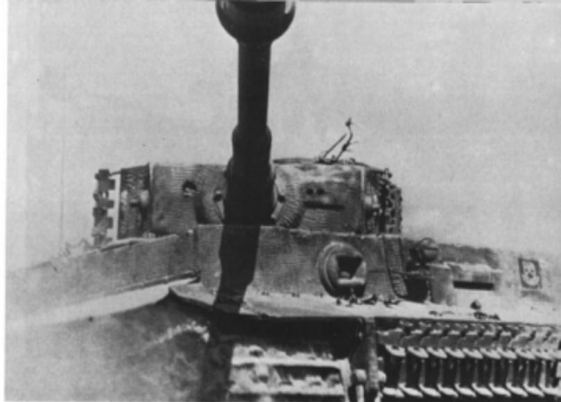
Oben: Wie ein voll gepanzerter Ritter, drohend, und bereit, jeden Kampf aufzunehmen. Interessant die Halterung am Turm für ein MG zur Flugabwehr. Diese Halterungen wurden 1944 bei den im Westen eingesetzten Tigern angebracht. Der Tiger zeigt rechts das Zeichen des I. SS-Panzerkorps.
