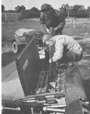
Die vier 12,7 mm Maschinengewehre in jeder Tragfläche konnten schnell aufmunitioniert werden. Hier sind Waffenwarte zu sehen, wie sie vorsichtig Gurte in die Munitionsbehälter einlegen.
