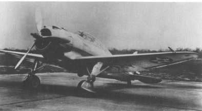
Oben: Die 77. P-35 wurde etwas verändert und erhielt die Bezeichnung XP-41. Aus ihr entwickelte sich die AP-4, die über YP-43 schließlich die Bezeichnung P-43 erhielt.
