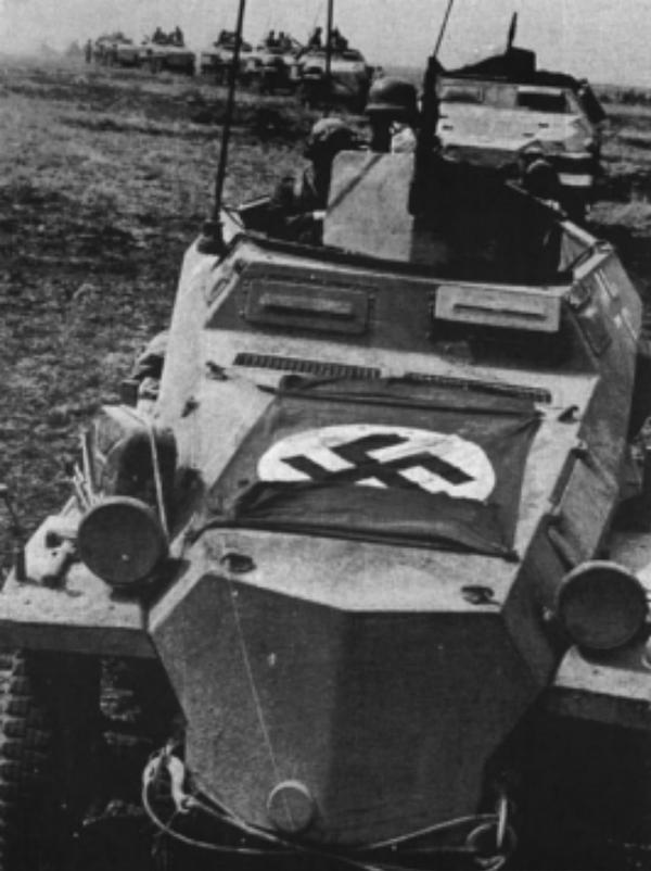
Nach der zweiten Antenne auf dem vorderen Wagen zu urteilen, könnte es ein Sd.Kfz. 250/3 sein. Diese Fahrzeuge gibt es aber auch mit anderer Antennenbestückung.
