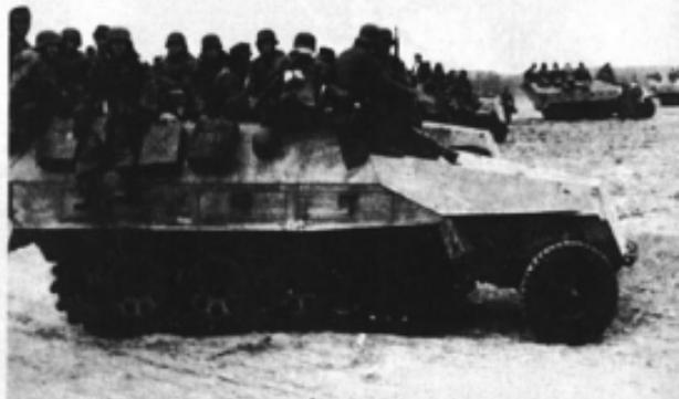
Bis auf die beiden oberen Fotos der linken Seite zeigen alle anderen Bilder die Ausführung D mit dem schrägen Heck.
