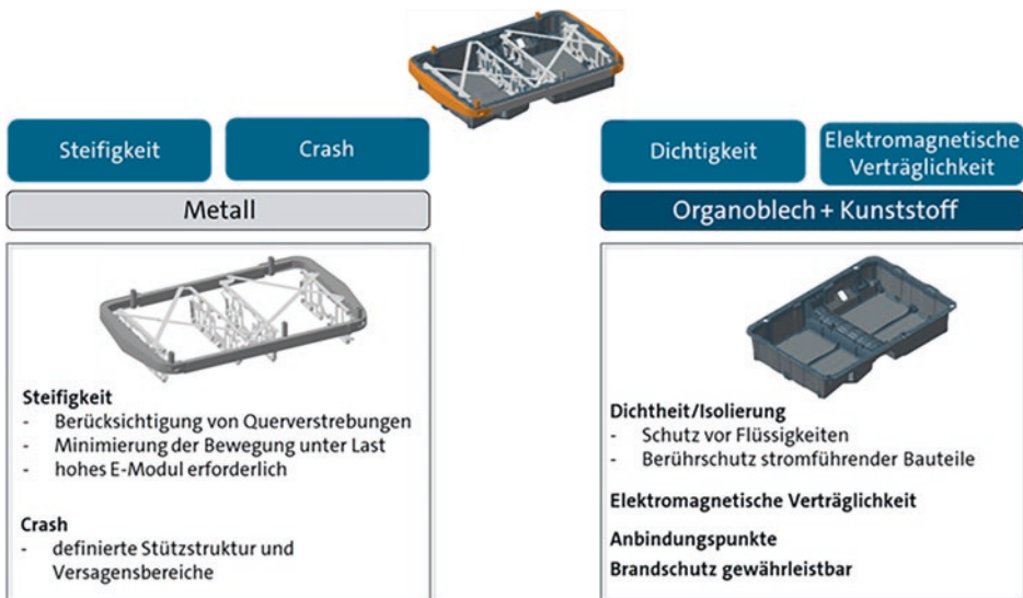
Abb. 4.2 Funktionen der Einzelkomponenten des Batteriegehäuses
