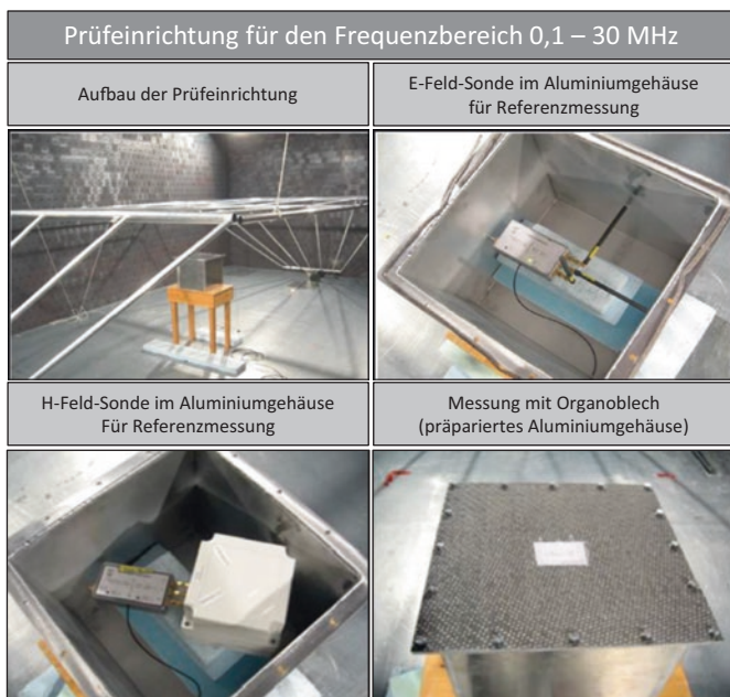
Abb. 16.3 Prüfeinrichtung zur Überprüfung des Elektromagnetische-Verträglichkeit-Schutzes
