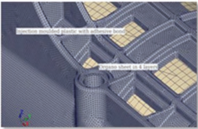
Verbindung Kunststoff / Organoblech
