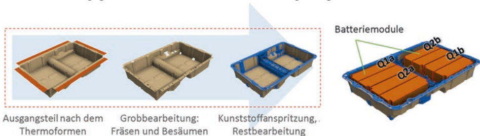
Abb. 15.11 Bearbeitungsschritte für die prototypische Prozesskette des Batteriewannendemonstrators. (Quelle: Simon Hickmann, 2018, nicht veröffentlicht, überarbeitet durch Autorin [1])
