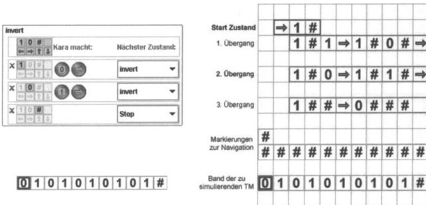
Abb. 5.12. Kodierung des Bitstring-Invertierers für die TuringKara-UTM
