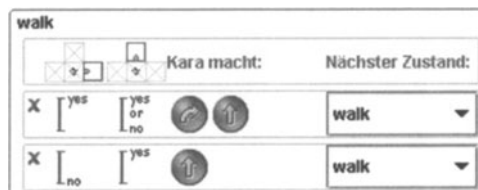
Abb. 7.9. Programm für „Strasse ablaufen“
