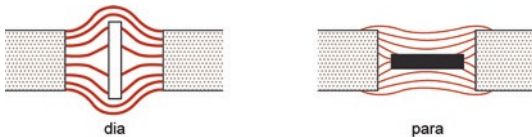
■ Abb. 3.8 Prinzipieller Verlauf der Feldlinien eines diamagnetischen (links) und paramagnetischen Stäbchens (rechts) im Magnetfeld
