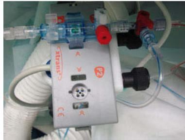
Abb. 2.13 Druckdom mit Anschlussmöglichkeiten für zwei Druckaufnehmer.
