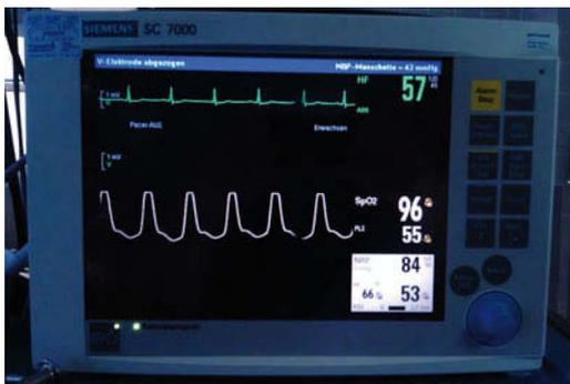
**Abb. 2.2** Integrierter Patientenmonitor zur Überwachung von **EKG** (grüne Kurve), **Herzfrequenz** (hier: 57), **SpO<sub>2</sub>** (weiße Kurve, hier: 96%), **Puls** (hier: 55), **nicht-invasivem Blutdruck** (hier: 84/53 (66)) und **Temperatur** (hier nicht dargestellt).
