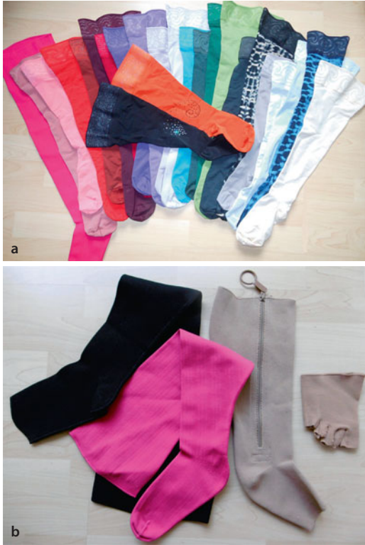
■ Abb. 6.8a,b a Strümpfe im Rundstrickverfahren; b Strümpfe und Teilelemente im Flachstrickverfahren. (Fotos: Kerstin Protz)
