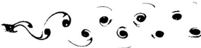
**Abb. 4.5** Kármán'sche Wirbelstraße (aus: M. Van Dyke: *An Album of Fluid Motion*, The Parabolic Press, Stanford CA, 1982)
