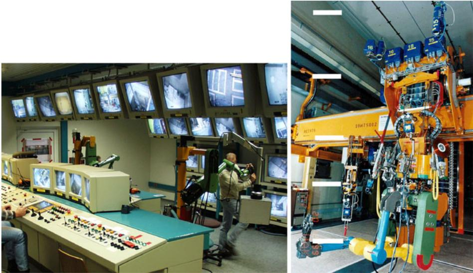
**Abb. 1.5** Einsatz des Master-Slave-Systems EMSM3 der telerob-GmbH im Kernkraftwerk. *Links:* Kontrollzentrum mit zwei Master-Robotern. *Rechts:* Slave-System, bestehend aus zwei Manipulatoren, in der heißen Zelle eines Kernkraftwerks (dargestellt ist ein Übungs-Szenario); mit freundlicher Genehmigung der Kerntechnischen Entsorgung Karlsruhe GmbH
