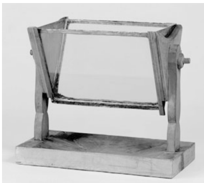
Großes Wasserprisma aus Goethes Besitz; abgebildet in den Beyträgen zur Optik (2. Stück, 1792) und in Zur Farbenlehre (1810), Tafel XVI.
