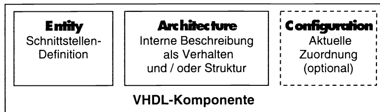
Abbildung 8.19 Design-Units einer VHDL- Komponente
