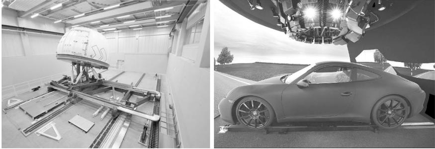
**Abbildung 1.1:** Außen- (links) und Innenansicht (rechts) des Stuttgarter Fahr-simulators [8]
