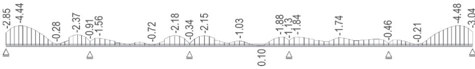
**Bild 2-154** Spannungen auf der Trägeroberseite im Endzustand für die häufige LK für  $\min M_y, t = \infty, \gamma = 0,9$
