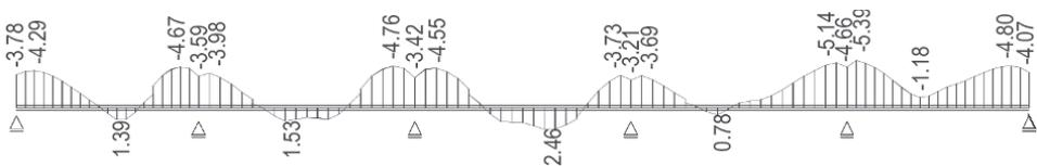
**Bild 2-153** Spannungen auf der Trägeroberseite im Endzustand für die häufige LK für  $\min M_y$ ,  $t = 0$ ,  $\gamma = 1,1$
