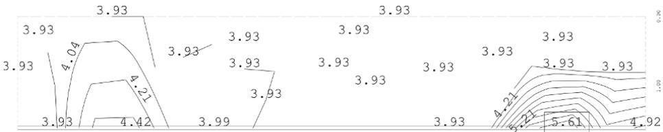
**Bild 5-68** Biegebewehrung Kammerwand Querbewehrung 2. Lage luftseitig – vertikal [cm<sup>2</sup>/m]
