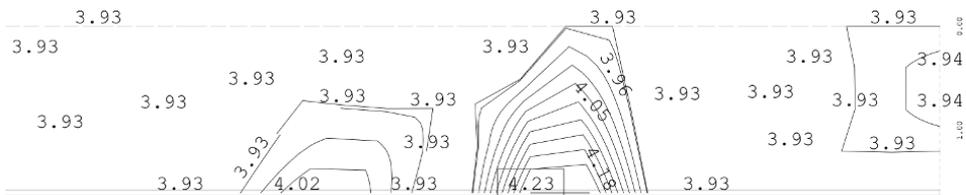
**Bild 5-70** Biegebewehrung Kammerwand Querbewehrung 2. Lage erdseitig – vertikal [cm<sup>2</sup>/m]
