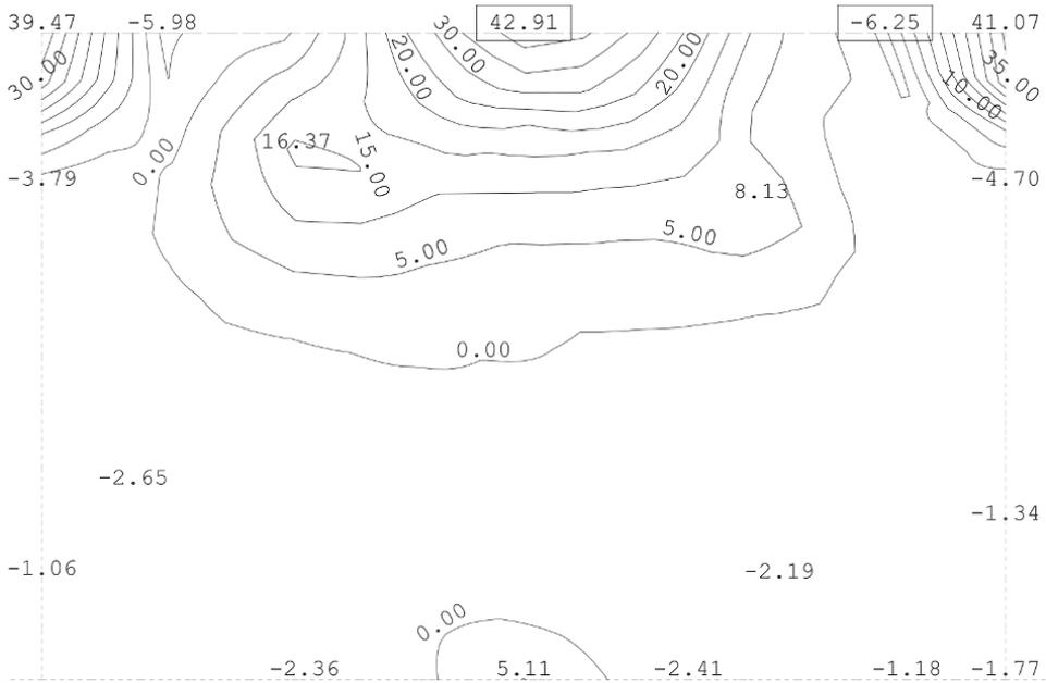
**Bild 5-111** Bewehrungsspannung unter der charakteristischen Lastkombination – Widerlagerwand luftseitig [MN/m<sup>2</sup>]
