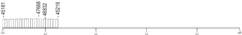
**Bild 2-48** Schnittkraftverlauf N [kN] für P aus BA1
