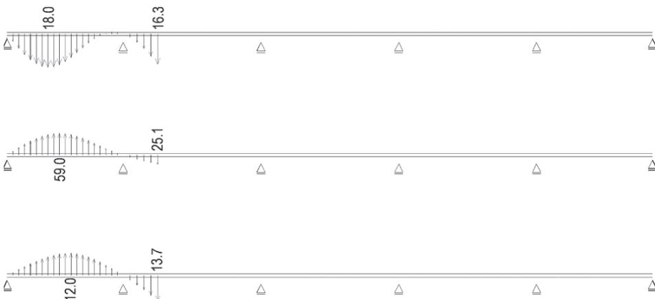
**Bild 2-156** Verformung BA1 aus  $g_1, P, K + S + R$
