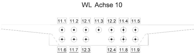
**Bild 2-42** Spanngliednummerierung WL Achse 10
