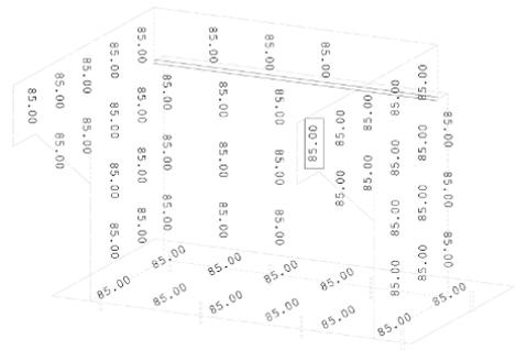
**Bild 5-58** Vorgegebene Eingangsparmeter Bewehrung – Schwerpunktabstand der Bewehrung vom Bauteilrand [mm]. a) obere bzw. luftseitige Hauptbewehrung, b) obere bzw. luftseitige Querbewehrung (2. Lage), c) untere bzw. erdseitige Hauptbewehrung, d) untere bzw. erdseitige Querbewehrung (2. Lage)
