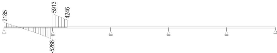
**Bild 2-45** Schnittkraftverlauf Q [kN] für  $g_1$  aus BA1
