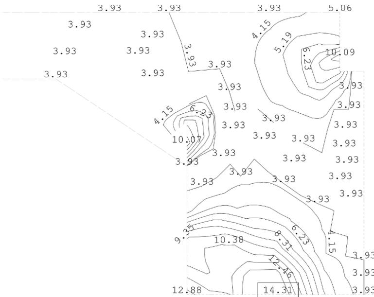
**Bild 5-74** Biegebewehrung Flugelwand Querbewehrung 2. Lage erdseitig – vertikal [cm<sup>2</sup>/m]
