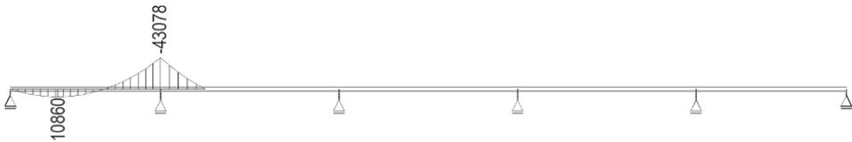
**Bild 2-44** Schnittkraftverlauf M [kNm] für  $g_1$  aus BA1
