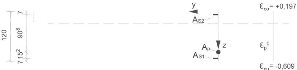
**Bild 2-140** Geometrie und Dehnungsebene unter der quasi-ständigen Kombination
