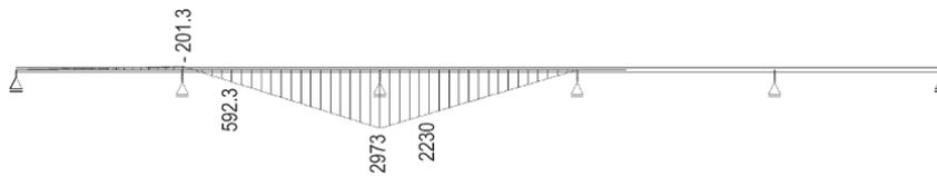
**Bild 2-63** Schnittkraftverlauf M [kNm] für K + S aus BA3
