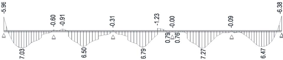
**Bild 2-125** Betonspannungen im Endzustand unten, selten, max  $M_y$ ,  $t = \infty$ ,  $\gamma_{inf} = 0,9$
