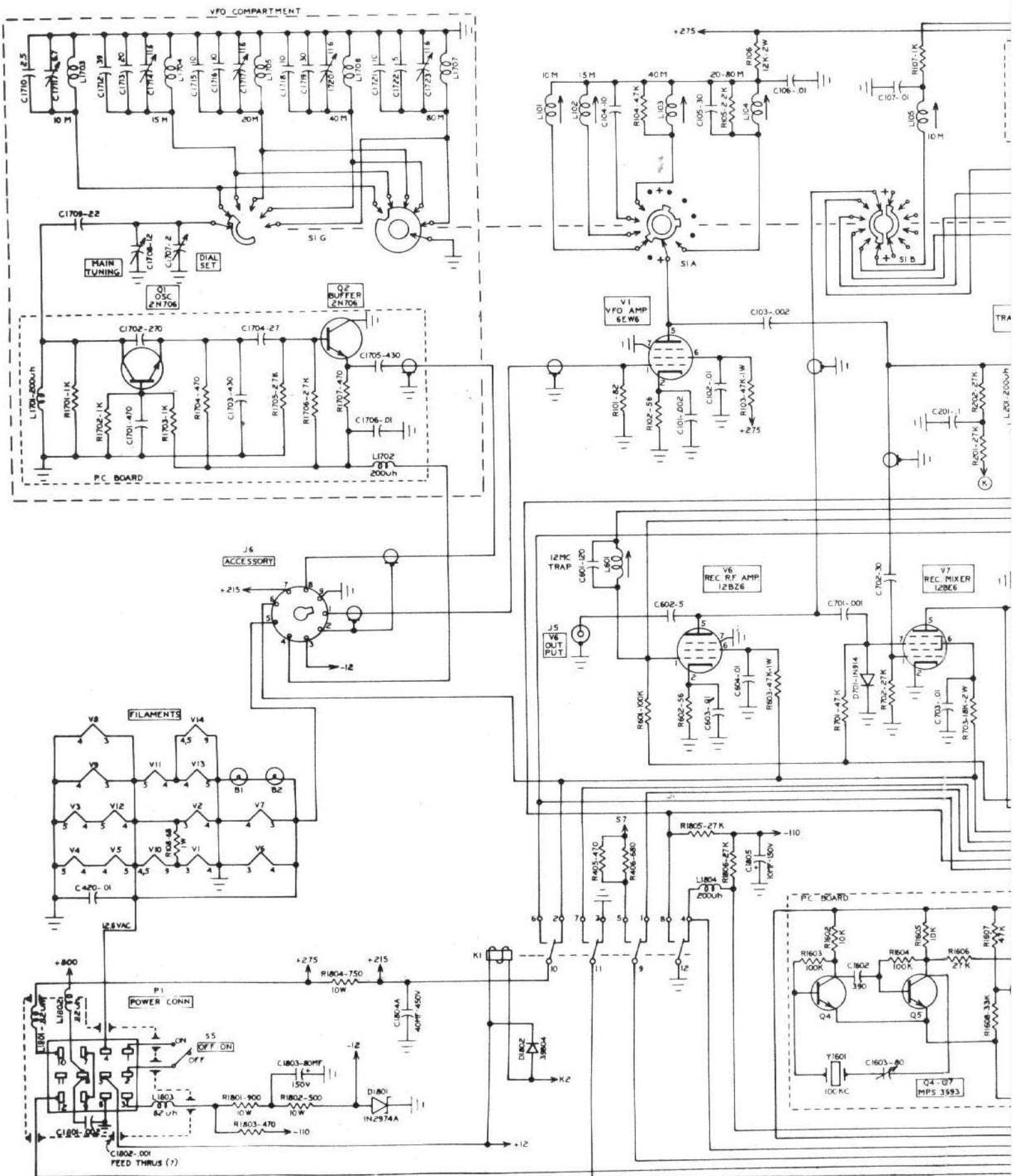
SCHEMATIC DIAGRAM - SWAN MODEL 500CX SINGLE SIDEBAND TRANSCEIVE
