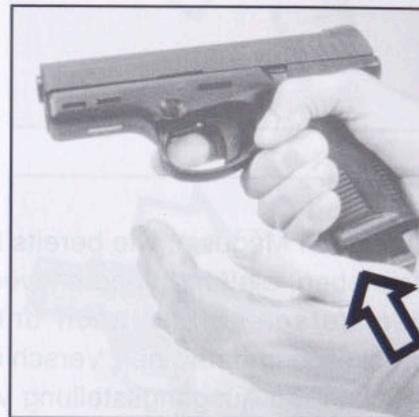
Die Waffe mit der Schußhand erfassen und mit der zweiten Hand den Verschußstück bis zum Anschlag zurückziehen und in die Ausgangsstellung vorschnellen lassen.
