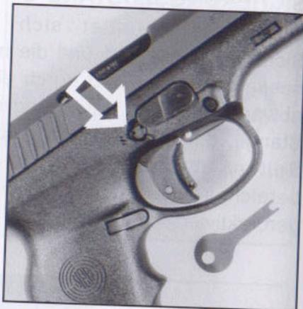
Die Wirkung der Schlüssel- Funktionssperre wird aufgehoben, indem der in die Öffnungen eingeführte Schlüssel mittels Druckausübung und Sperrbewegung in Richtung des auf dem Griffstück ersichtlichen Buchstaben „F“ (Fire) gebracht wird.
