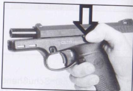
Das neue Magazin, wie bereits beschrieben, einführen und entweder den Verschußfang nach unten drücken und damit den Verschußstück in die Ausgangsstellung vorschnellen lassen
