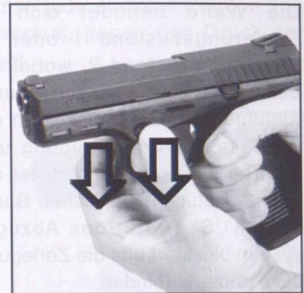
Ein Teil dieser Sicherung ragt in den Abzugsbereich, wobei auf beiden Seiten jeweils ein weißer Punkt sichtbar ist. Die Abzugsbetätigung und Schußauslösung wird verhindert.
